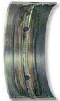
机油稀释造成的轴承磨损
